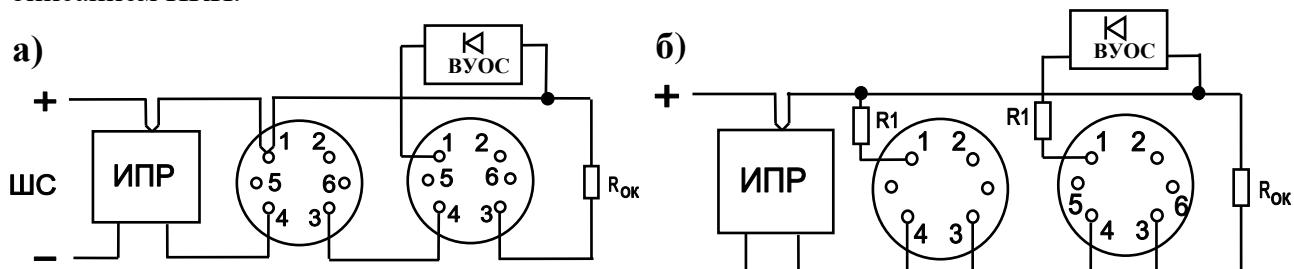
Рис.3. Схемы включения извещателя для приборов с однополярным шлейфом сигнализации: а) – типовая; б) – различающая срабатывание одного и двух извещателей в шлейфе. Величина резисторов определяется в соответствии с техническим описанием ПКП.
